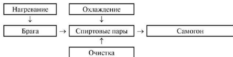
Рис. 1. Схема процесса перегонки
